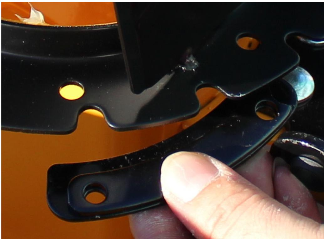
③ 黒い金具を2枚重ねて投雪口の下部にあて、上からボルトを差込み、下側からはワッシャーとナットで締めます。
