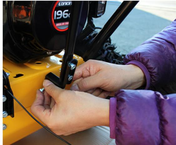
③ ギアチェンジバーを固定したら、下部のボルトをハンドルが動かしやすい程度に張り具合を調整して、右に締めてください。
